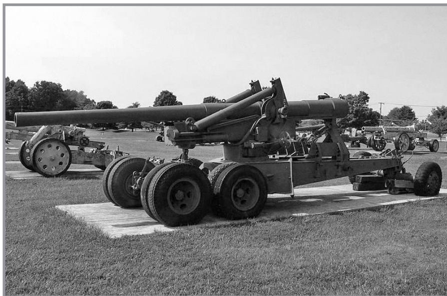
Het 155 mm kanon "Long Tom" in vervoerspositie. Het schootsbereik was bijna 26 km; de vuursnelheid maximaal 5 schoten per minuut. Ook de Nederlandse artillerie beschikte in de koude oorlog periode over een afdeling met deze stukken (foto uit archief heemkundevereniging).
