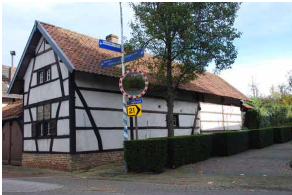
1 Hellebrook, vakwerkhoeës aan 't Zjwierdervootpaad, besjtoande oet 4+2 gebonter; jök mèt kröppel sjtiele op d'r ankerbalk; divergerende sjtieëpe d'ronger. Kuueningske op d'r wirvel. Lange sjoarbalk en lankgerekde vakke in d'r ziewand. 2017
